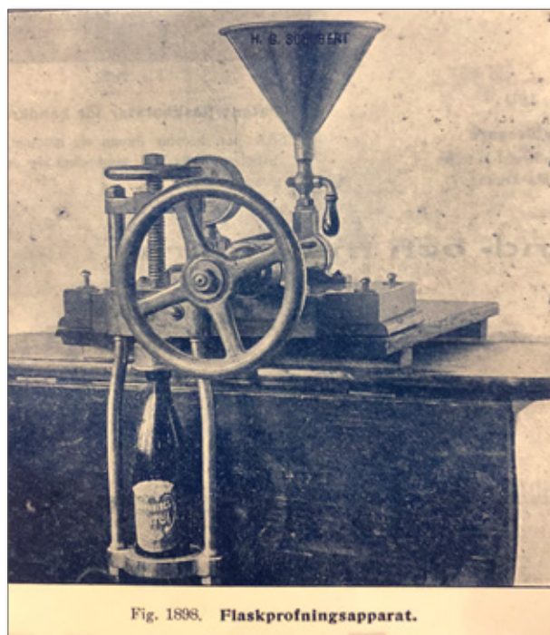
"Flaskprofningsapparat" ur inbunden broschyr från HG Schuberts bryggerimaskinaffär 1908.
